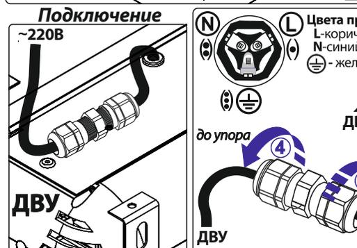
Установите ДВУ рамку 1 на монтажную поверхность и закрепите ее с помощью 2-х(4-х) винтов, болтов, анкеров (в комплект не входят).
