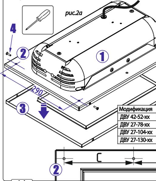
2. Разметьте место крепления светильника на монтажной поверхности. Если необходимо вырежьте проем для установки изделия (см.таблица1) и установите в него светильник 1 с рамкой ДВУ 2.
